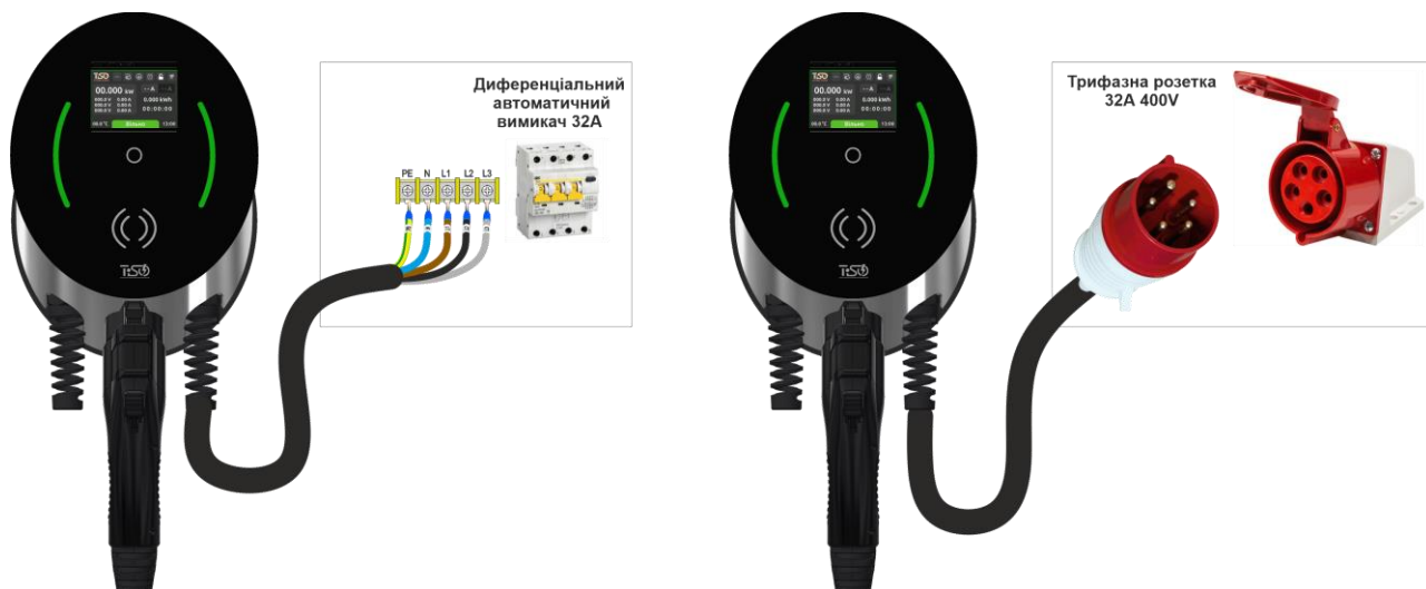
Рис.7 – Варіанти підключення трьохфазної зарядної станції
